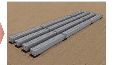
세그먼트 조립 및 긴장 조립대를 이용한 정밀 접합 및 강연선 긴장
